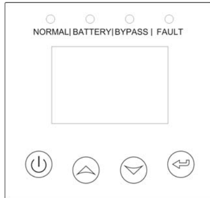
Fig. 5-1 Pannello di controllo
