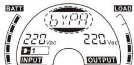
■ Figura 6.3 Modalità Bypass (Bypass mode)
